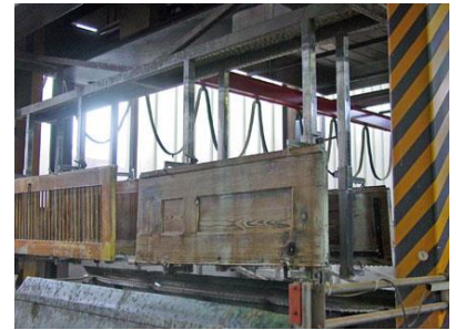
Foto III: Fensterläden im Ablaugevorgang
